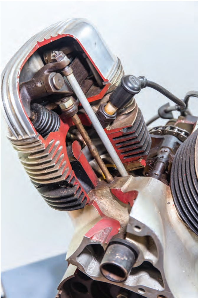
Schnittmotor, der im Victoria-Werk für die Händler- und Werkstattschulung eingesetzt wurde.
