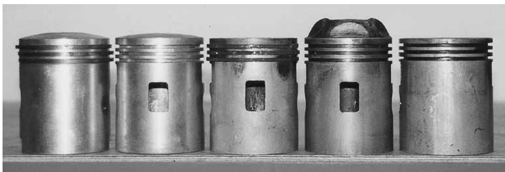
Aero-Kolbenparade v.l.n.r.: KR 25 HM/KR26, Nachrüstvariante des KR 25-Kolbens mit erhöhtem Kolbenboden, die beiden KR 25-Serienkolben Flach- und Muldenversion, KR 25 S.
