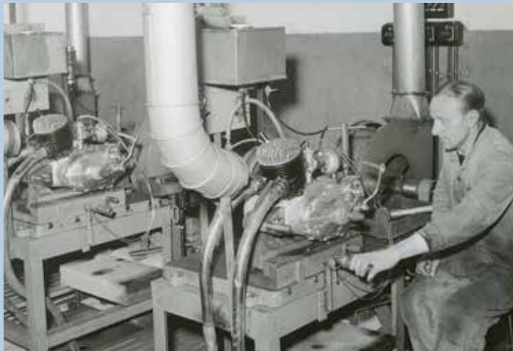
Motorprüfstand im Victoria-Werk ca. 1952.
