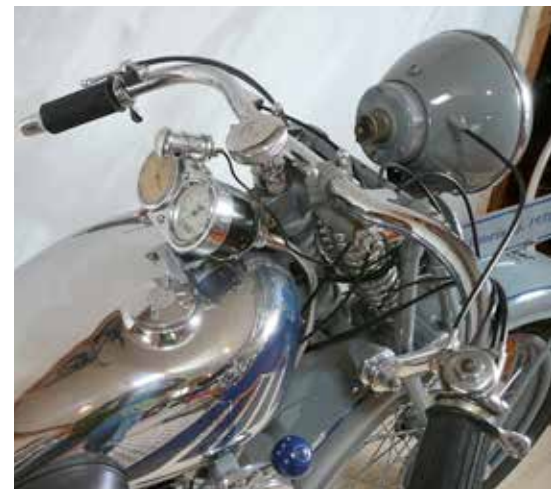
Das Fahrercockpit mit Tachometer und Zeituhr. Von Graetzin wurden die sogenannten „Flügelarmaturen“ für Zündverstellung (links) und die Luftregelung (rechts) geliefert.
