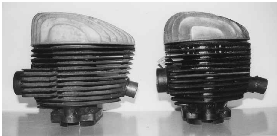
Links der Zylinder der letzten Aero-Ausbaustufe von der KR 26 mit großen Kühlrippen. Der Unterschied zur Kühlrippenfläche des HM-Zylinders (rechts) wird am deutlichsten sichtbar im Bereich vom Vergaserstutzen.
