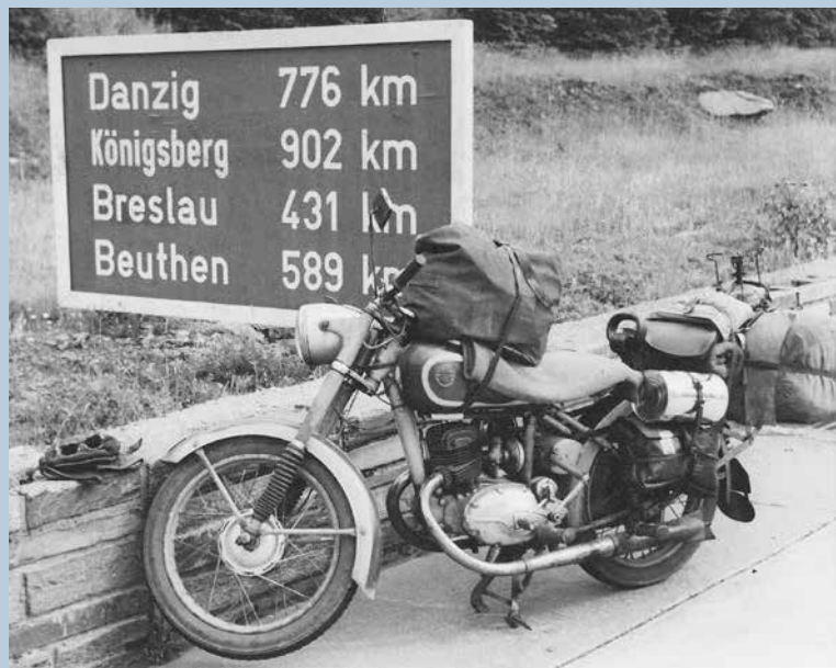
KR 25 HM (Foto oben und unten) in schwarzer Lackierung mit Jurisch-Hinterradfederung.
